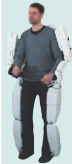
L'EXOSQUELETTE permet de rétablir la connexion entre l'intention du mouvement et son exécution après section de la moelle épinière.
