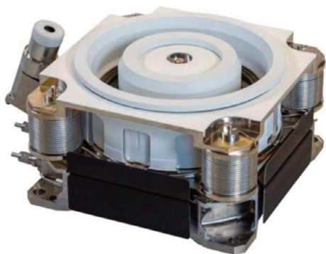
Figure 4. À gauche : Moteur plasmique (Safran). À droite : Moteur plasmique PPS®1350-G en fonctionnement. Crédits Eric Drouin/Snecma/Safran.
