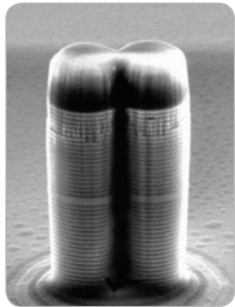
*Micropiliers (diamètre 3 micromètres) utilisés pour créer des états quantiques de la lumière*
