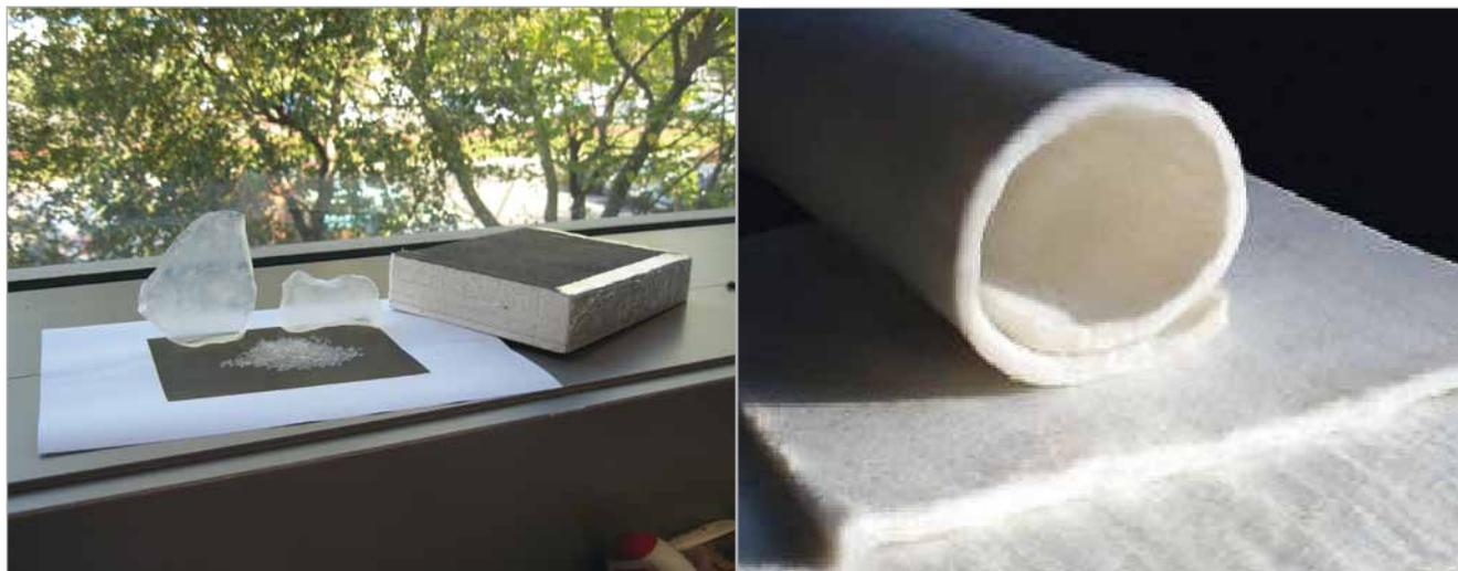
Figure 1 Aérogel translucide et feutre d'isolation à base d'aérogel
