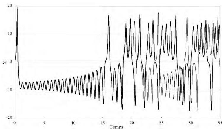
Fig. 7 - Système de Lorenz. Une des variables en fonction du temps. On distingue les deux mouvements vaguement périodiques avec des basculements entre eux pratiquement imprévisibles.
