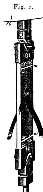
mettre une traction exercée à l'aide de poids placés dans un plateau (*fig. 2*). L'extrémité H est suspendue à un crochet fixe. A l'extrémité inférieure B vient s'accrocher une tige qui transmet la traction des poids. Les faces opposées de la lame de quartz (*fig. 1*) sont recouvertes de feuilles d'étain, telles que  $mn$ ,  $m'n'$ , isolées, sur lesquelles se dégage l'électricité. Les ressorts légers  $r$ ,  $r'$  mettent ces feuilles d'étain en communication avec les appareils électriques.
