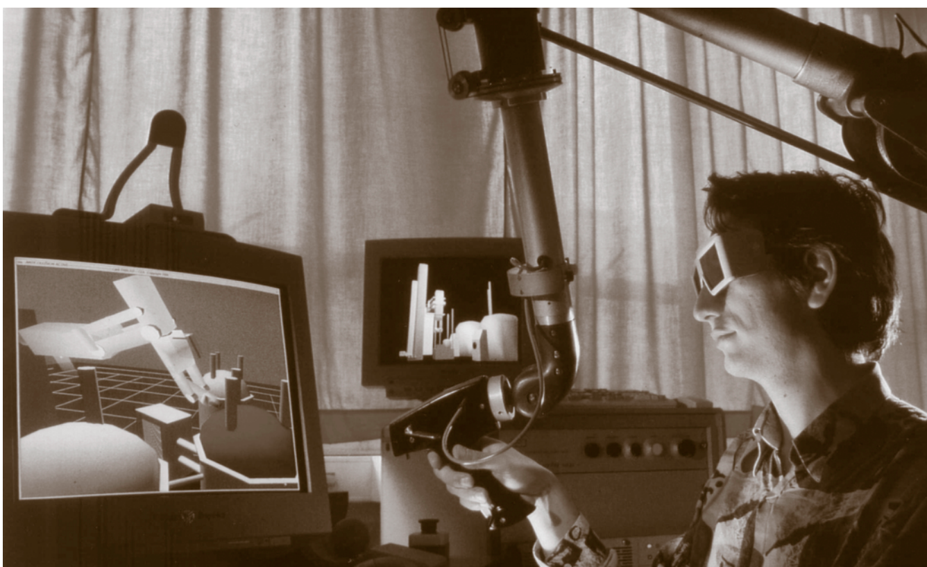
Système de téléopération pour des applications nucléaires. L'opérateur, en activant le bras maître à retours d'efforts et en utilisant des lunettes redonnant le relief, manœuvre au sein du monde virtuel, copie du monde réel, comme s'il était présent.
