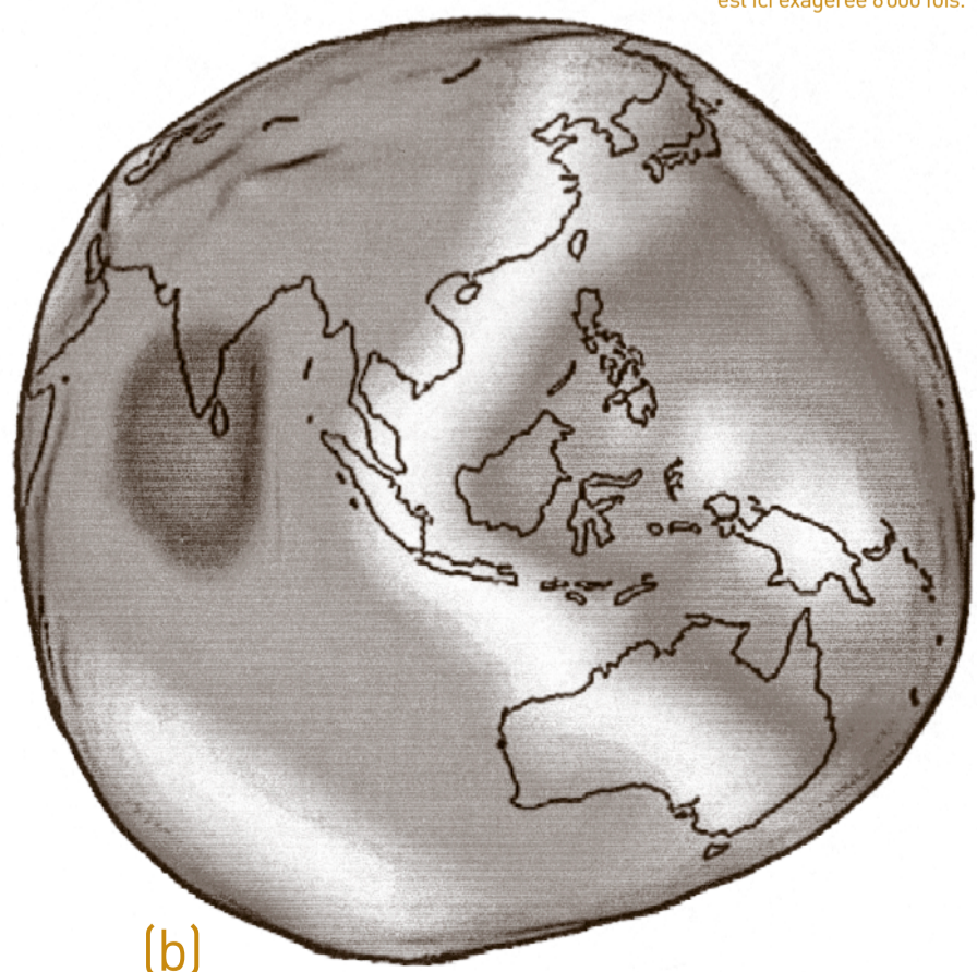
Fig. 1. La surface du géoïde, rapportée à une ellipsoïde approximant la forme géométrique de la Terre, reflète les variations de densité liées à la structure interne (a). L'amplitude des creux et bosses du géoïde (b) atteint \pm 100 \text{ m} (elle est ici exagérée 6 000 fois).
