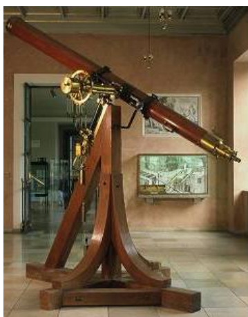
Fig. Lunette de Fraunhofer de 23 cm d'ouverture utilisée par Galle à Berlin lors de la découverte de Neptune à la position signalée par Le Verrier (1846). Elle se trouve au Deutsche Museum de Munich.
